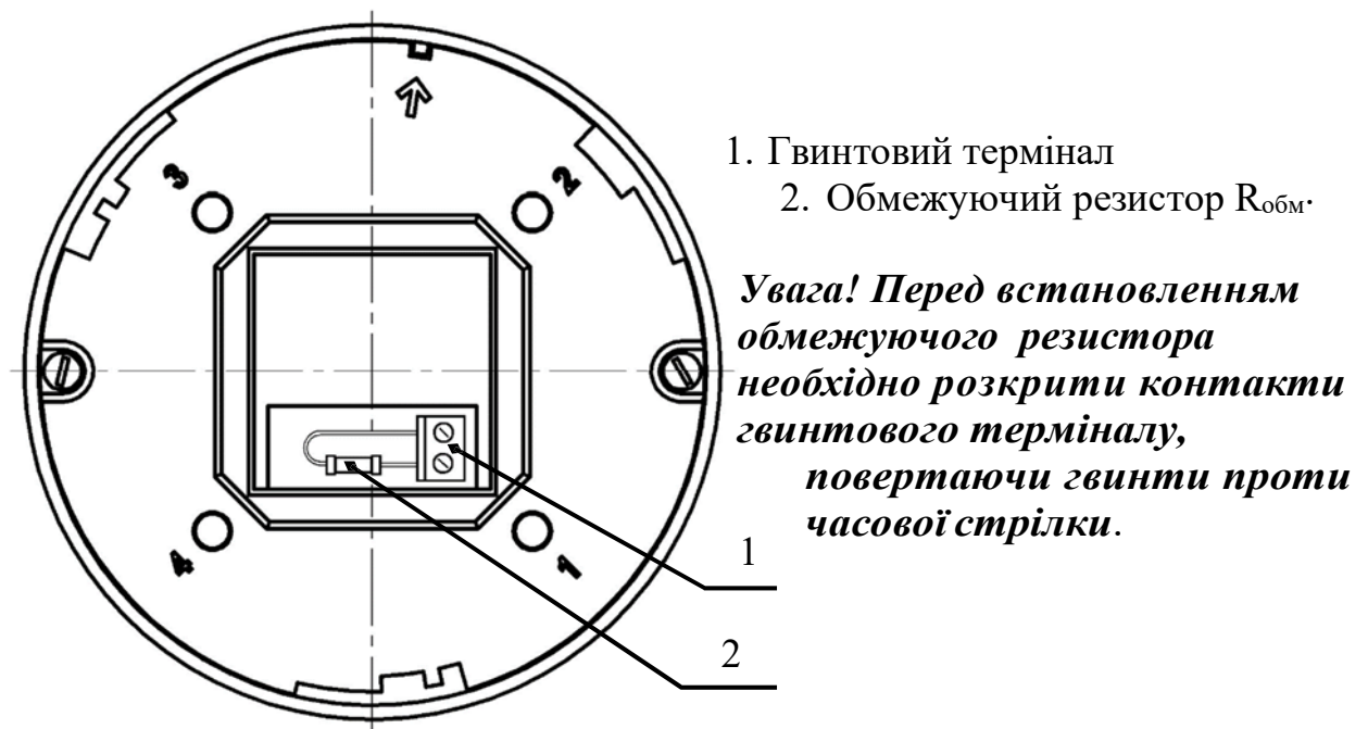
Рис. 2 Встановлення обмежувача резистора R_{обм} .
